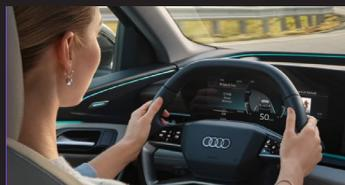
**Récupération d'énergie** : Le système de récupération aide à récupérer de l'énergie, aussi bien en roue libre que lors du freinage. La récupération en roue libre est activée lorsque vous levez le pied de l'accélérateur. Le degré de récupération est sélectionné automatiquement ou manuellement à l'aide des palettes au volant.
